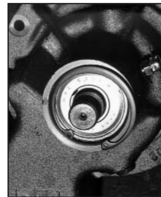
VHO-206, reteniendo el eje de una bomba de agua en su ranura.
