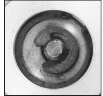
Anillo HOI con orejeta invertida que ofrece un mayor espacio libre para un anillo E (centro) en esta válvula de carrete de una transmisión automática.
