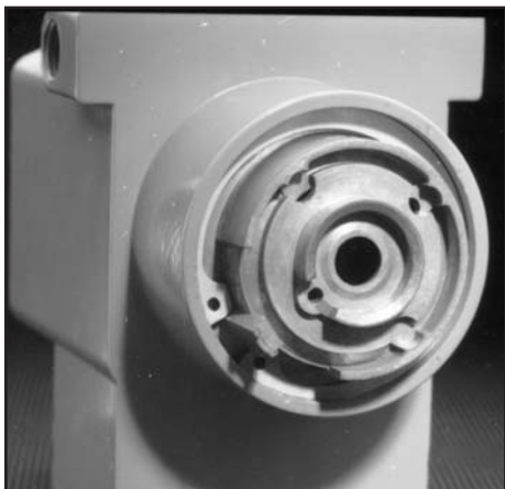
Anillo HO que retiene la válvula en este conjunto de molde.
