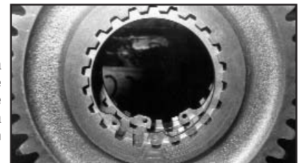
SH-237 utilizado para retener los engranajes del conjunto de eje principal de la transmisión de un camión.
