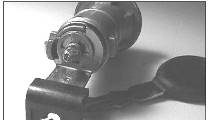
Anillo de retención BE en un conjunto de motor de arranque de un automóvil.
