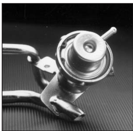
Anillo HO interno que retiene la válvula de este conjunto de distribuidor de combustible.
