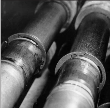
El anillo LC de dos partes se equilibra dinámicamente una vez instalado, haciéndolo muy efectivo en la retención de este conjunto de escalador a altas velocidades de rotación.
